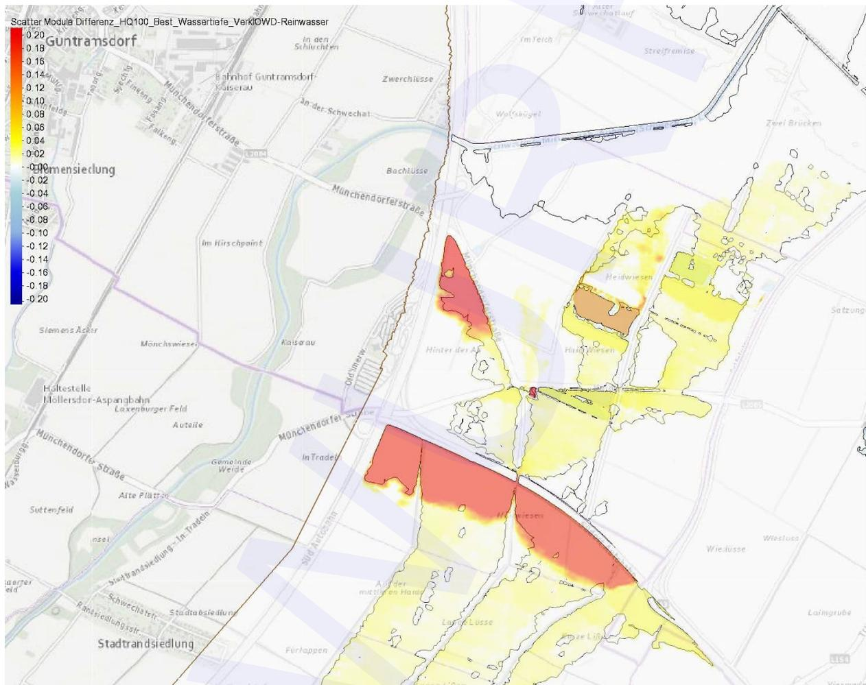
Abbildung 40: Detail Guntramsdorf: Differenz Wasserspiegel/Wassertiefe HQ<sub>100</sub>, Berechnung Verkläuerung Objekte Oberwaltersdorf minus Reinwasserberechnung; Farbverlauf Wasserspiegelanhebung im Wertebereich 0-20cm (gelb-rot), Wasserspiegelabsenkung (blau); Anschlaglinie Reinwasser (schwarze Linie), Farbverlauf gelb-rot in Bereichen außerhalb der schwarzen Anschlaglinie Reinwasser stellt durch die Verkläuerungen zusätzlich überflutete Flächen dar
